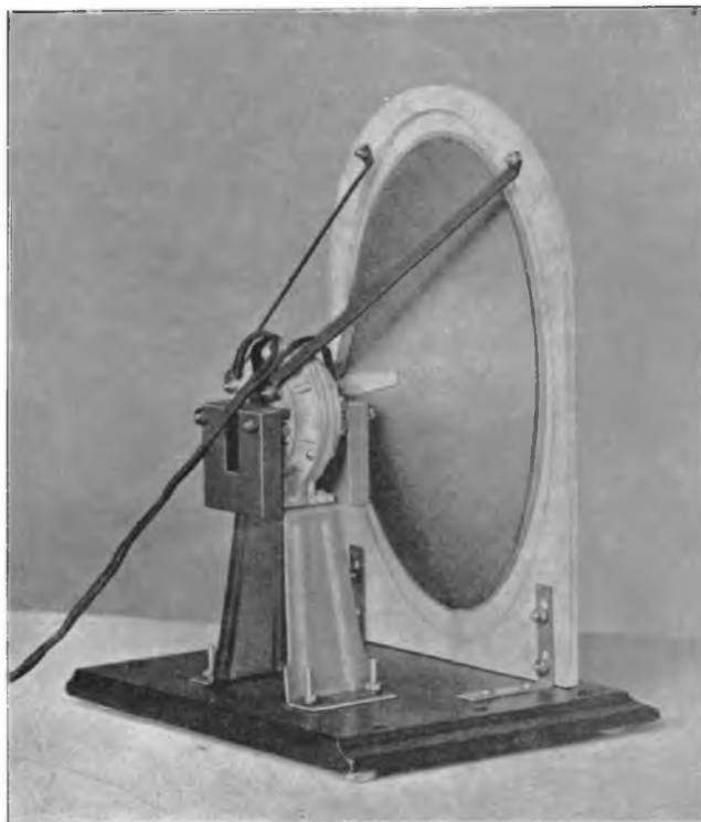
De foto toont het inwendige van den Brandes Luidspreker.
